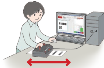
USBケーブルでPC接続し、検証物の上をスライドさせるだけで簡単検証。
